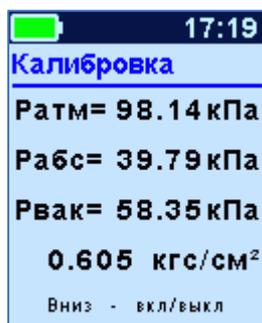
7.8.3 Провести аналогичные измерения по п. 7.8.2 вакуумметрического давления в следующих четырех точках контроля диапазона  $(0,5 \pm 0,01)$ ;  $(0,4 \pm 0,01)$ ;  $(0,3 \pm 0,01)$ ;  $(0,11 \pm 0,01)$  кгс/см<sup>2</sup>. Полученные данные занести в протокол.
