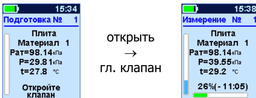
6.4.11 Дождаться окончания процесса измерения. Прибор автоматически вычислит сопротивление проникновению воздуха  $m$ , параметр воздухопроницаемости  $a$  и марку по водонепроницаемости  $W$ . Эта информация будет выведена на дисплей и сохранена в памяти прибора.
